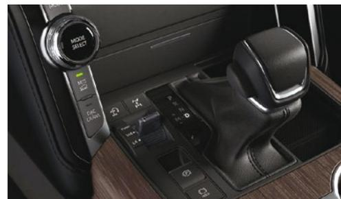
Caja automática de 10 velocidades con selector de modos de conducción.
