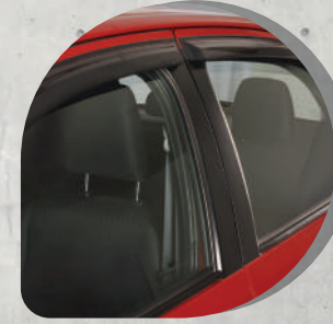
Deflector de viento
