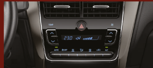
Aire acondicionado con climatizador automático digital. (1)
